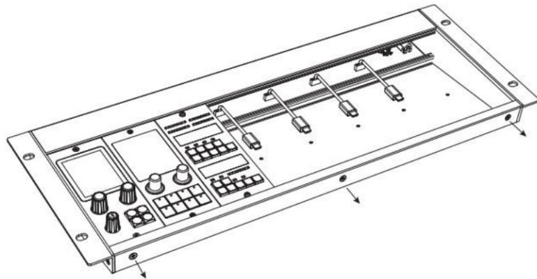
2. 从最近的 USB 连接器上取下塑料保护盖,然后小心地将其插入桌面控制器的 USB 端口。它是 Micro USB B;请注意正确插入。
