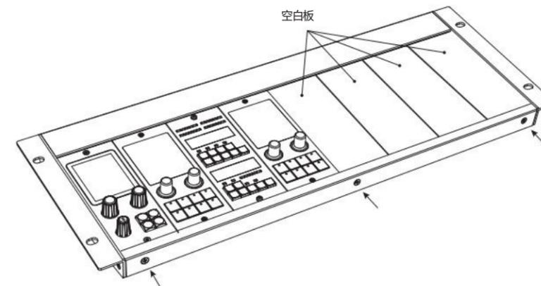
6. 在每个已安装控制器的底部面板中添加提供的螺钉。注意:在拧紧底部螺钉之前,您可以微调位置,使控制器之间的间距均匀且相等。
