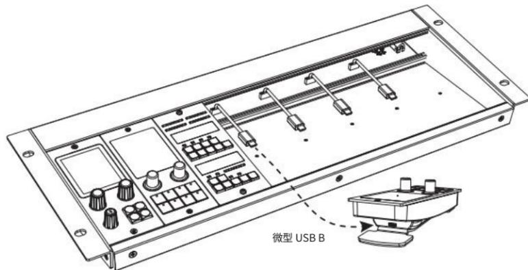
3. 将 USB 电缆塞入,以免被挤压。将控制器的顶部边缘插入扩展坞顶部导轨的凹槽中。降低控制器的底部边缘,准备好前边缘导轨滑回其上方。
