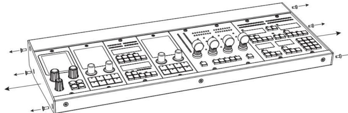
2. 使用相同的螺钉将机架耳安装在两端。牢固地拧紧螺钉。
